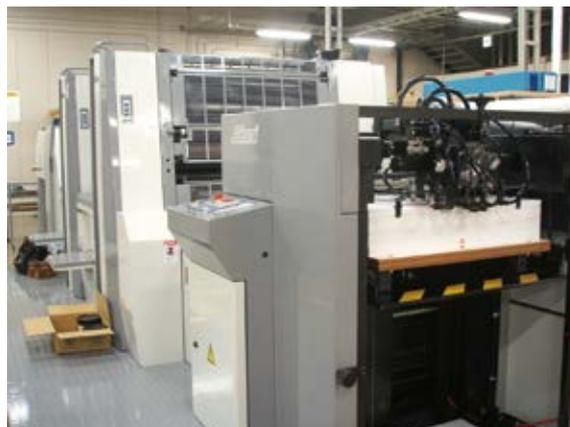
LED-UV方式の印刷機
