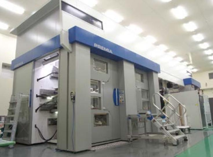
小山工場の水性フレキソ印刷機
