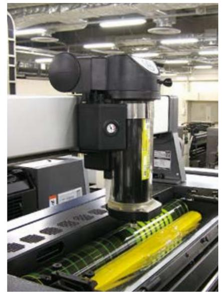
印刷機のインキ供給装置
