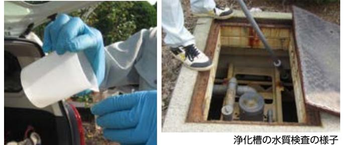
浄化槽の水質検査の様子
