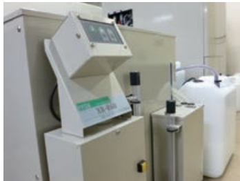
CTP 廃液の濾過装置
