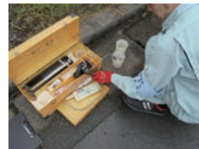
浄化槽の水質検査の様子
