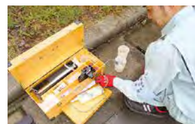
浄化槽の水質検査の様子
