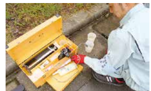
浄化槽の水質検査の様子
